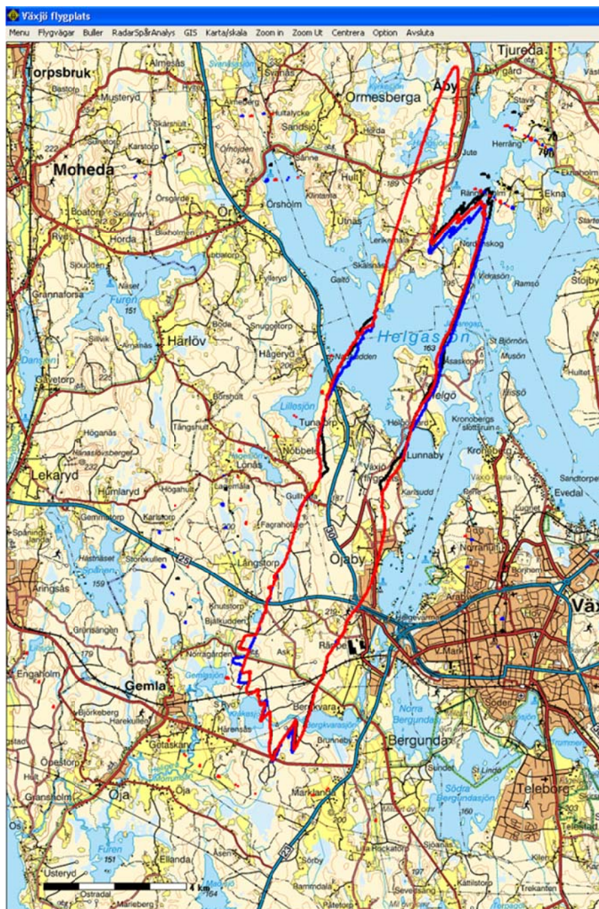
Figur 21 Redovisning maximal ljudnivå, L_{Amax} 70 dBA 3 ggr/dygn Svart linje befintligt bansyste, Blå linje förlängd bana 01, bi- behållande av svängpunketer relativt bansystem, Röd kontur, bibehållande av svängpunketer relativt geografiska lägena
