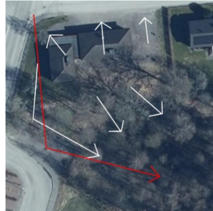
Bild från dagvattenutredningen (Norconsult 2023). Vita pilar visar avrinning från planområdet och röd pil visar kulverterad dagvattenledning.
