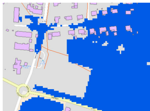
Bild över översvämningsutbredningen i anslutning till planområdet med en förhöjd marknivå (+ 155 m.ö.h.) inom det tidigare planområdet vid ett beräknat högsta flöde i Mörrumsån (+154,73 m.ö.h.).
