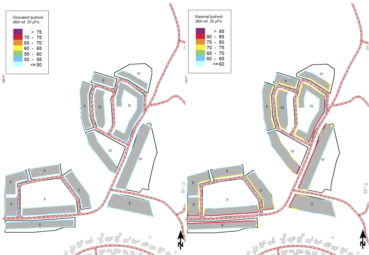
Figur 8 Ekvivalent och maximal ljudnivå från vägtrafik. Färgmarkeringen avser högsta nivån vid någon våning.
